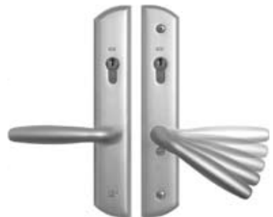
Serie 2811 afgeschuind No-Risk Fast-Out functie: kruk omlaag en vluchten
